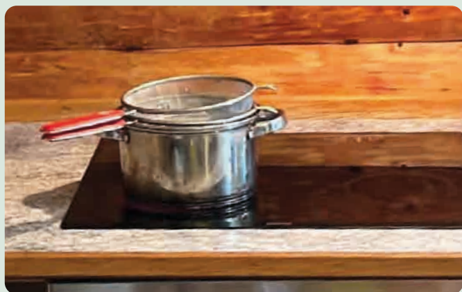
Ar glicerīnu uzpildīts katls termokoksnes iegūšanai.
